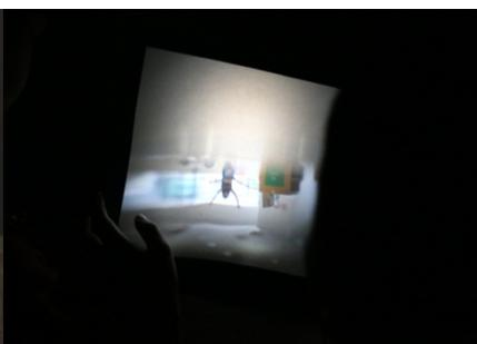
まずはカメラオプスキュラの実験！おはなし室を真暗にして“カメラの中”に見立て、カメラの中で像が写る仕組みを体験します。小さな穴を通して、外の風景が逆さまにシートに写し出されました！
